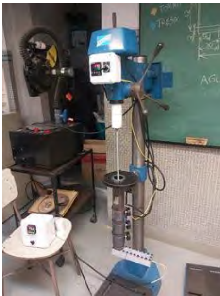
Imagen 21- Inyectora de banco terminada, con molde y controladores de temperatura
