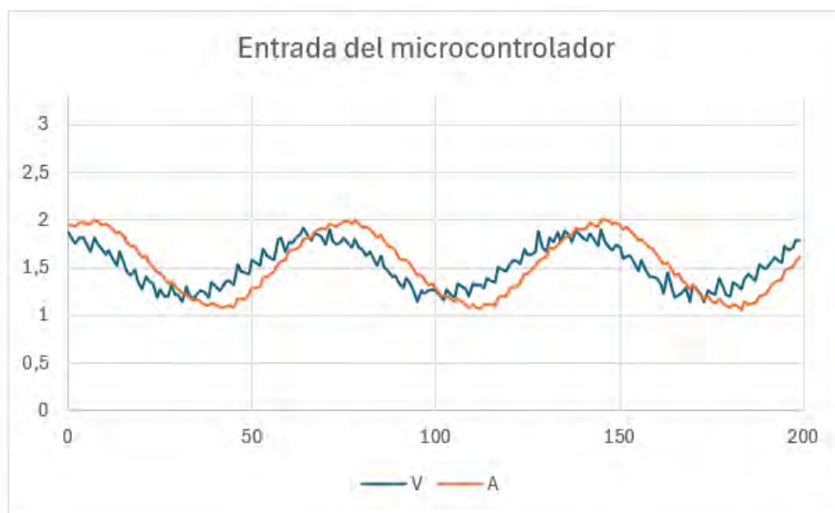
Figura 3 Señales brindadas por los sensores usando fuente conmutada de 220 VAC a 5 VDC.
