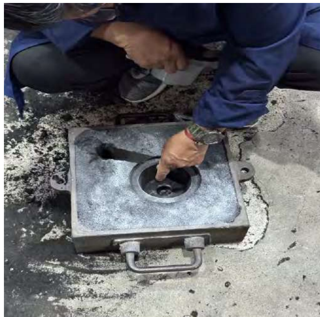
Imagen 13: Armado del canal de colada
