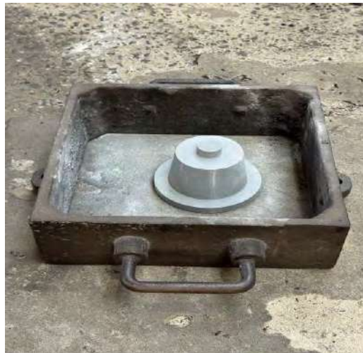
Imagen 6: molde con el talco antiadherente listo para colocar la arena
