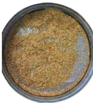
Figura 8: Fracción retenida en tamiz de malla Tyler 36
