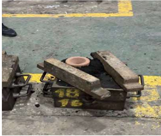
Imagen 14: molde finalizado con el bacín de colada
