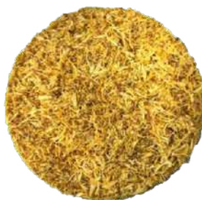
Figura 7: Harina gruesa de semilla de limón obtenida en la molienda
