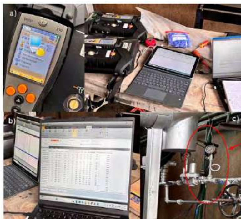
Figura 5 a) Testo 350 para toma de datos. b) Lectura de datos con el software testo easyEmission. c) Ubicación de los sensores en el ducto de salida de los gases de combustión.
