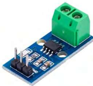
Figura 8 Módulo sensor de corriente basado en el ACS712
