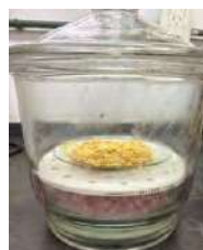
Figura 3: Estabilizado en desecador con sílica gel
