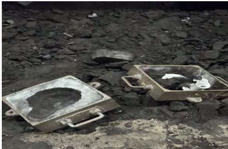
Imagen 18: molde y pieza luego de la fundición
