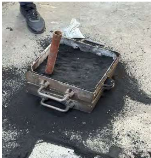
Imagen 9: Arena con el tubo para el bebedero
