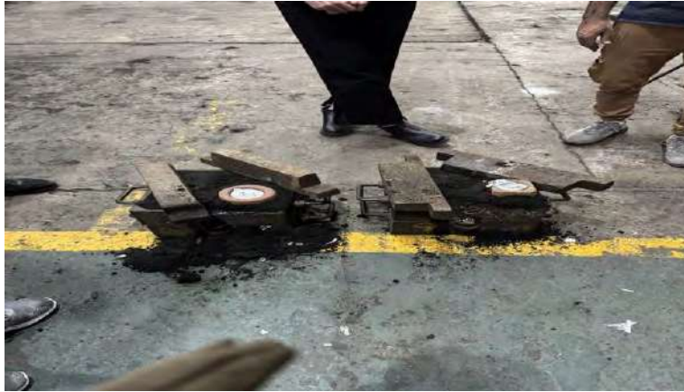
Imagen 17: Moldes con el aluminio fundido dentro
