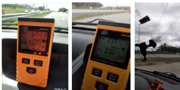
Figura 13: Equipo Benetech sobre vehículo, testeando valores de campo. Fuente Propia.
