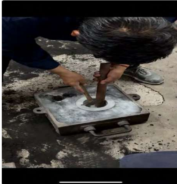
Imagen 12: Extracción del modelo de dentro del molde
