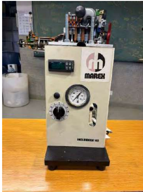
Imagen 22 - Inyectora derivada de inclusora metalográfica, vista frontal
