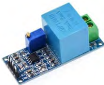
Figura 5 Módulo sensor de tensión basado en el ZMPT101B
